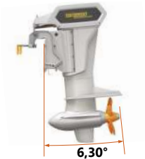
Abb. 23: Motor vollständig heruntergekippt
