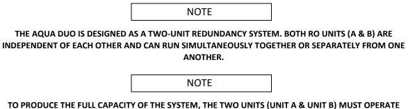
O PRODUCE THE FULL CAPACITY OF THE SYSTEM, THE TWO UNITS (UNIT A & UNIT B) MUST OPERATE SIMULTANOUSLY.
