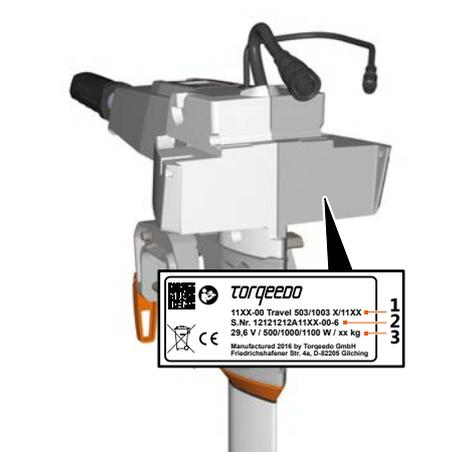
Abb. 1: Typenschild Travel System
