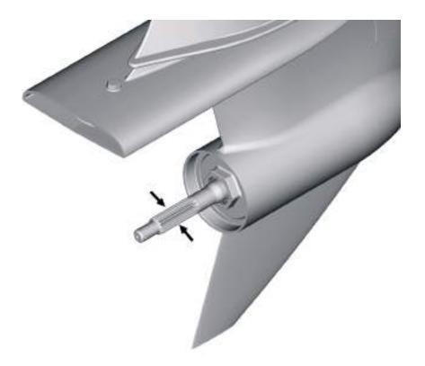
Fig. 11 Propeller shaft
