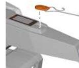
Fig. 41: Llave magnética de parada de emergencia
