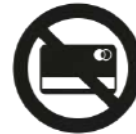
Magnetkarten (z. B. Kreditkarten) und andere magnetisch sensible Informationsträger min. 50 cm Abstand halten.
