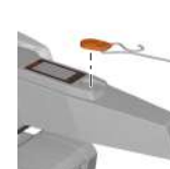
Fig. 39: Llave magnética de parada de emergencia
